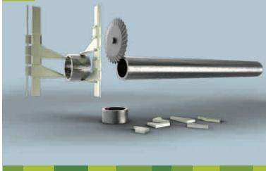
Отбор проб для проведения механических испытаний и определения химического состава
